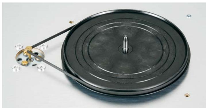
**Der Kunststoff-Innenteller wird von einem geschliffenen Flachriemen angetrieben, der auf einem Metall-Motorpulley sitzt. Gut zu sehen auch die Alu-Auflage auf dem MDF.**
