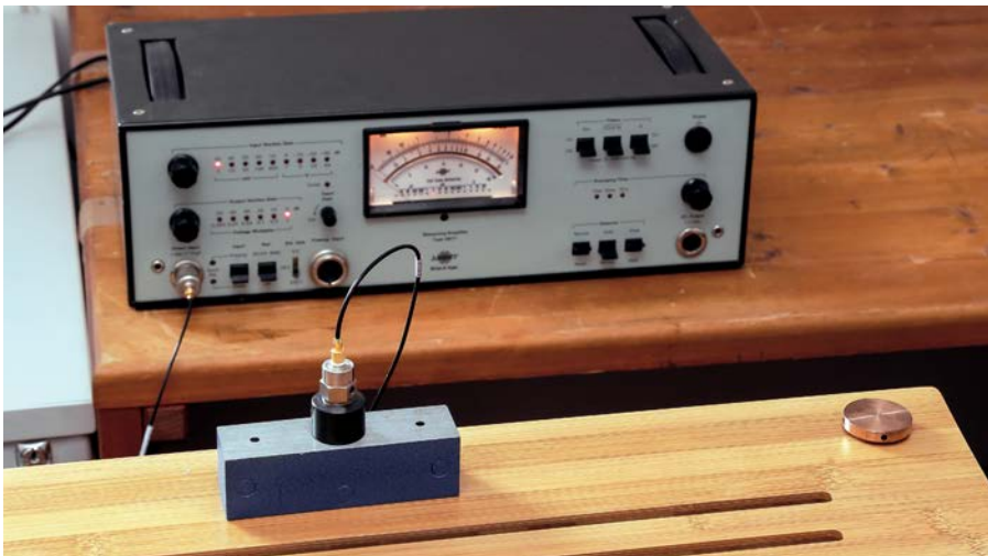
▲ Die breitbandig angeregten Racks wurden alle mit einem Brüel & Kjaer-Beschleunigungsaufnehmer und definiertem Sweep auf der Top-Ebene gemessen, einmal pur und mit drei (!) Plattenspielern.
